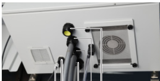
figura 3-24 Connessioni sulla parte inferiore dell'alloggiamento (da sotto) Esempio: 2 canali campioni, 1 drenaggio
